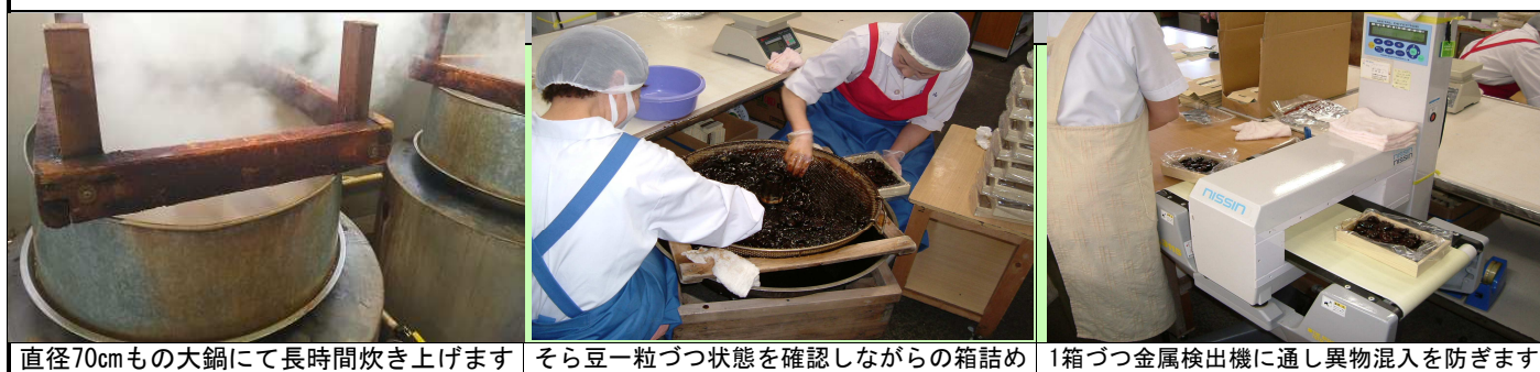
直径70cmもの大鍋にて長時間炊き上げます | そら豆一粒ずつ状態を確認しながらの箱詰め | 1箱ずつ金属検出機に通し異物混入を防ぎます
