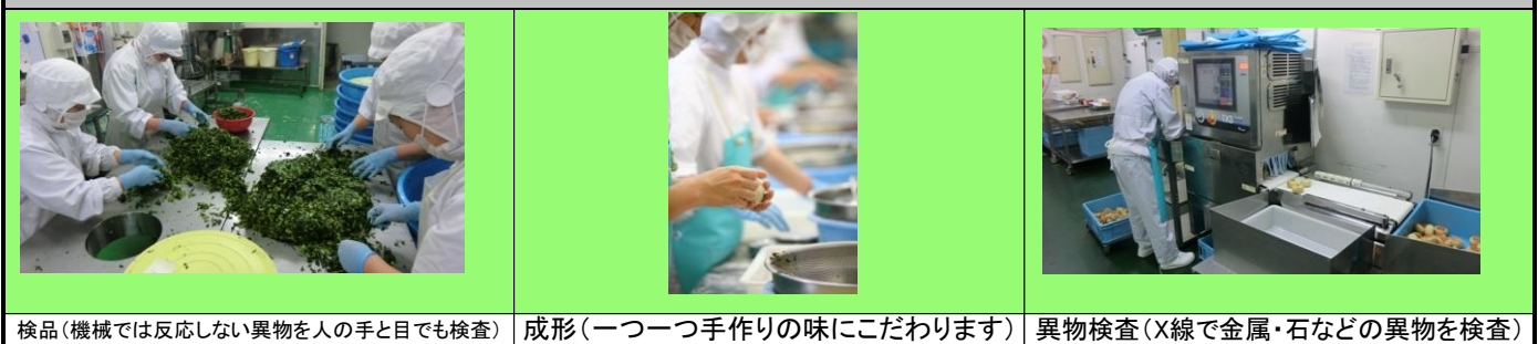
検品(機械では反応しない異物を人の手と目でも検査) 成形(一つ一つ手作りの味にこだわります) 異物検査(X線で金属・石などの異物を検査)
